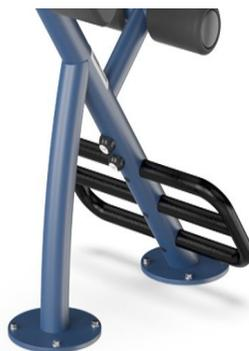
Tous les composants en acier sont fabriqués en acier au carbone, avec une surface galvanisée à chaud selon ISO1461, et un revêtement en poudre classe de corrosion C3 selon ISO12944-2. La teneur en plomb pour les surfaces est inférieure à 90 ppm et inférieure à 100 ppm pour le matériau de base.
